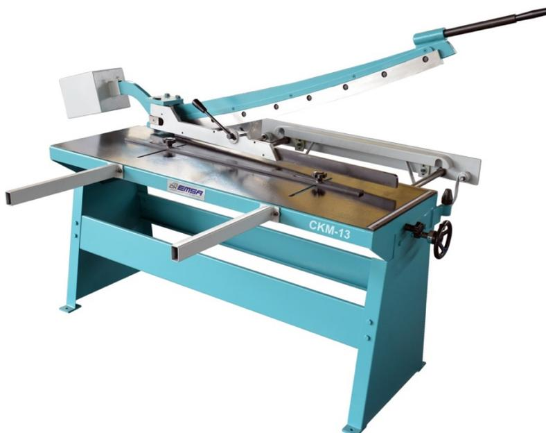
Открытая конструкция для раскроя материалов неограниченной длины. Металлическая конструкция стола, прямоугольная стопорная рельса. Верхний резак сделан с противовесом. Задний упор с пружинно нагруженным стопорным рельсом, регулируемые маховик и стойки. Линейка стола настраивается для выполнения скошенных разрезов в соответствии с угловой шкалой.
