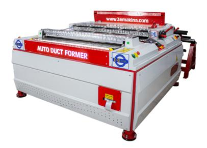
Автоматическая линия ККМ-02 (1500) применяется для производства заготовок прямоугольных воздуховодов путем резки и гибки рулонного металла для последующего фальцевого соединения.
