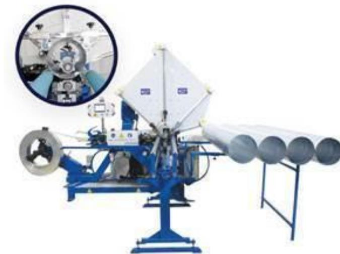
Спирально-навивной станок TFWSI предназначена для производства воздуховодов желаемого диаметра и длины. Машина более экономична и проста в эксплуатации, чем аналоги. Станок имеет качественный процесс сшивания. В качестве альтернативы стандартным диаметрам можно изготавливать бесконечные трубы разных размеров. Изготовленные воздуховоды соответствуют требованиям EUROVENT и SMACNA.
