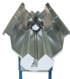
Станок тоннельной сборки SeamCloser выполняет три операции за один процесс: формовка фальцев, соединение фальцев, фальцеосадка. Незаменим при использовании автоматической линии для гибки прямоугольных воздухопроводов из рулонной стали. Получаемый шов отличается высокой плотностью и качеством, играет роль дополнительного ребра жёсткости. Низкое электропотребление. Низкие шумовые характеристики.
