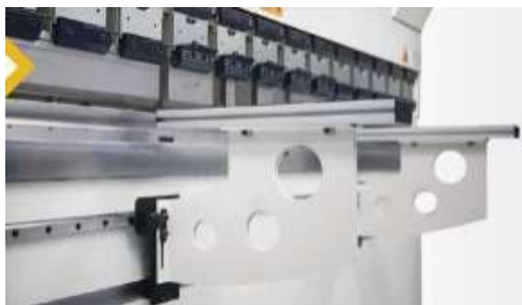
Передние опорные рычаги со щетками установлены на системе линейных направляющих.
