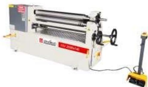
Электромеханические вальцовочные станки предназначены для изготовления изделий из металла цилиндрической формы.
