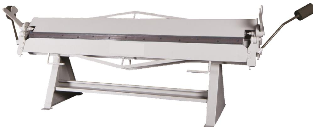
Изготовление комплектующих вентиляции и других изделий из листового металла. Листогиб СКМ-02 имеет простую и надежную сварную конструкцию, противовесы гибочной балки. Двухстороннее управление позволяет работать одновременно двум рабочим при гибке заготовок максимальной толщины. Прижимная балка спроектирована для гибки деталей малого сечения из одной заготовки.
