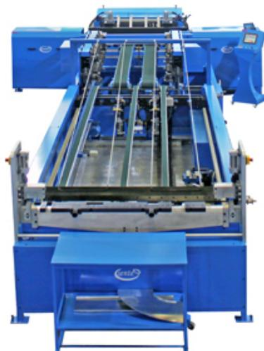
На этой линии производятся каналы с интегрированным фланцем типа TDF / TDC. Производство осуществляется автоматически под управлением монитором. Кроме того, каждой станцией можно управлять отдельно с панели управления. Таким образом, можно также производить квадратные воздуховоды со стандартными крепежными фланцами.
