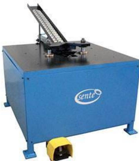
Станок устанавливает угловой аппарат на воздуховод, необходимый для соединения самофланцевых воздуховодов друг с другом болтами. Угловая подача происходит автоматически с помощью угловой камеры на машине. Таким образом, процесс крепления выполняется быстро и создается безопасная рабочая среда, поскольку оператору не нужно вмешиваться вручную.
