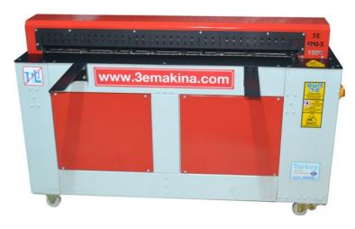
Используются в производстве прямоугольных воздуховодов. Ребра жесткости придают дополнительную прочность вентиляционным коробам. Z- Профилирование уменьшает вибрацию каналов при прохождении через них потока воздуха. Станки отвечают требованиям мобильности и надёжности, предъявляемым современными условиями производства воздуховодов.
