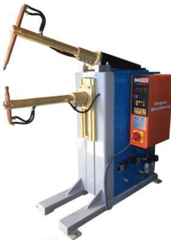
Стационарная машина DSZ 45 производства компании Dogan Machinery (Турция) предназначена для двухсторонней контактной точечной сварки.
