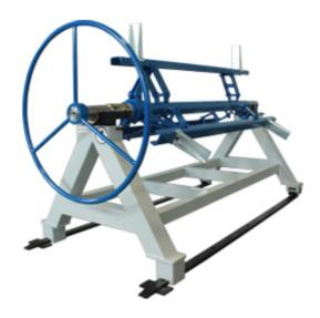
Разматыватель UCN5000 — механизм, применяемый для размотки рулонного листового металла. Устанавливается в производственную линию совместно с листогибами, машинами резки, профилирующими установками. Обеспечивает плавную размотку рулона при экономии рабочего пространства цеха. Оснащен удобным механизмом самоцентровки рулона с равномерным разжатием по внутренней цилиндрической поверхности.
