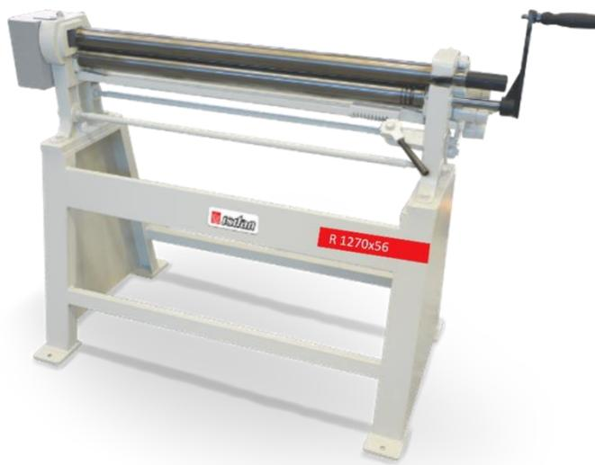
Механический вальцовочный станок, управляемый вручную с помощью приводной рукоятки, имеет простую конструкцию. Ручные вальцы состоят из открытой чугунной станины рамного типа и трехвалкового гибочного устройства (два опорных вала и один прижимной вал).
