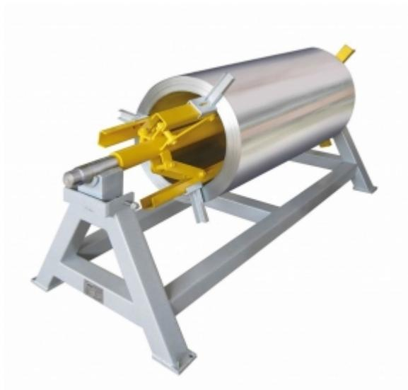
Размотчик UCN7000 (с мотором) предназначен для размотки листового рулонного металла. Оснащен станиной, которая равномерно производит подачу. Данная модель рассчитана на вес до 7 тонн. Вращение осуществляется с помощью подшипников.
