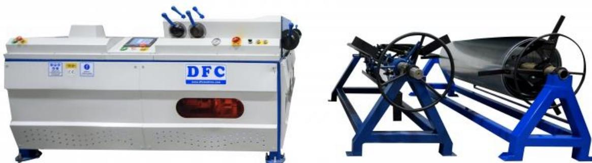
Станок для производства прямоугольных воздуховодов был разработан для производства заготовок прямоугольных воздуховодов путем резки и гибки рулонного металла.
