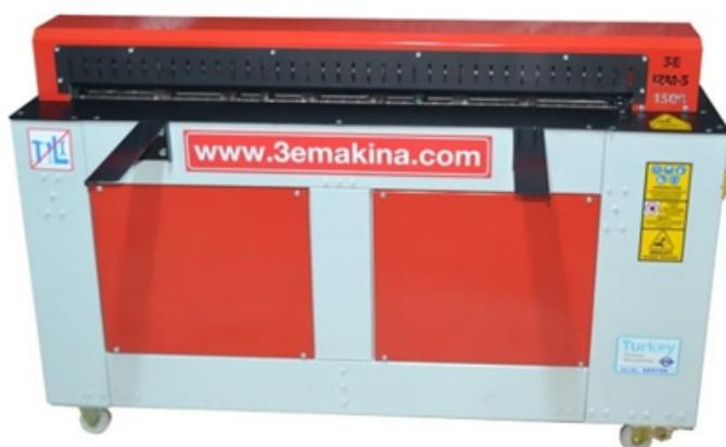
Станок для нанесения рёбер жесткости 3E Makina IZ-04 используется в производстве прямоугольных воздуховодов. Ребра жесткости придают дополнительную прочность вентиляционным коробам. Z-профилирование уменьшает вибрацию каналов при прохождении через них потока воздуха.
