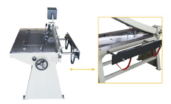
Гильотинные ножницы с емкостью 1300 х 1,5 мм из платинового листового металла. Лезвия марки Böhler будет служить вам в течение многих лет. Гильотинные ножницы имеют прочный сварной корпус, жёсткость которого позволяет обеспечивать высокую точность резки даже при больших механических нагрузках. При резке прижимным рычагом скольжение листа сводится к минимуму.
