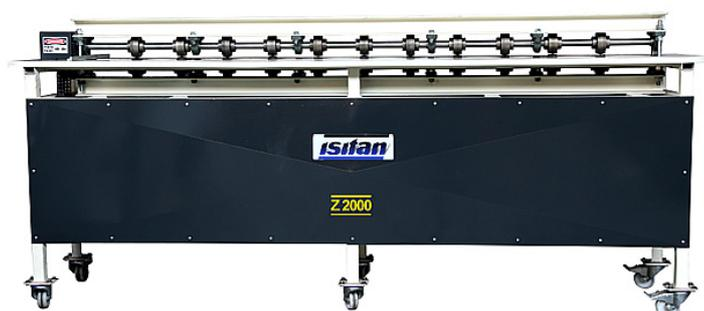
Используются в производстве прямоугольных воздуховодов. Рёбра жесткости придают дополнительную прочность вентиляционным коробам. Z- Профилирование уменьшает вибрацию каналов при прохождении через них потока воздуха. Станки отвечают требованиям мобильности и надёжности, предъявляемым современными условиями производства воздуховодов.
