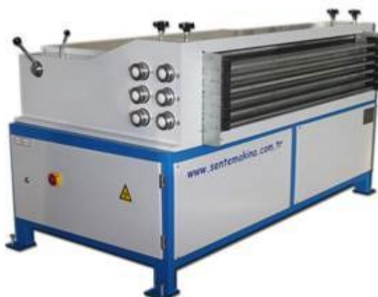
Для выравнивания металлического листа на выходе из разматывателя устанавливается специальное оборудование – правильно-подающий станок с электрическим приводом. Модель PFD-S-2 обладает высокой производительностью и применяется для правки металла толщиной 0,5...5 мм со скоростью 25 м/мин.
