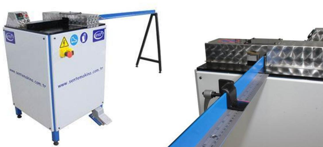
Станок предназначен для резки шинорейки, которую вы получаете по размеру, до нужного размера. Благодаря измерительной линейке до 1500 мм вы можете вырезать точно и без заусенцев. На машине есть счетчик количества. Счетчик автоматически сигнализирует, когда количество разрезов, которое вы хотите, завершено. Пневматическая педаль дает вам простоту использования.
