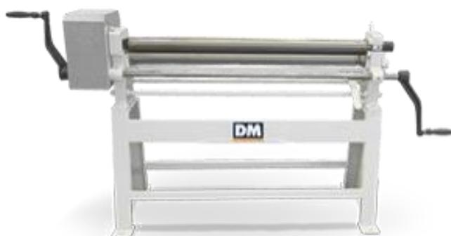
Ручной вальцовочный станок DRM 1050x56 уверенно вальцует оцинкованную сталь толщиной 1,0 мм.
