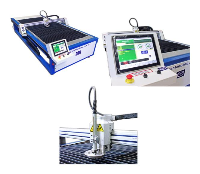
Станок-автомат плазменной резки предназначен для изготовления деталей дымоходов и воздуховодов. Оборудование позволяет выполнять высокопроизводительный раскрой листового металла с получением точных размеров и качественных гладких кромок. Мощная вытяжная система станка обеспечивает эффективное удаление дыма, образованного в процессе резки.
