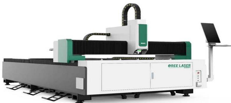
Портальные станки лазерной резки OREE LASER являются эффективными и надежными инструментами, предназначенными для резки, гравировки, пробивки отверстий в листовом металле с высокой точностью и качеством обработки по контуру.
